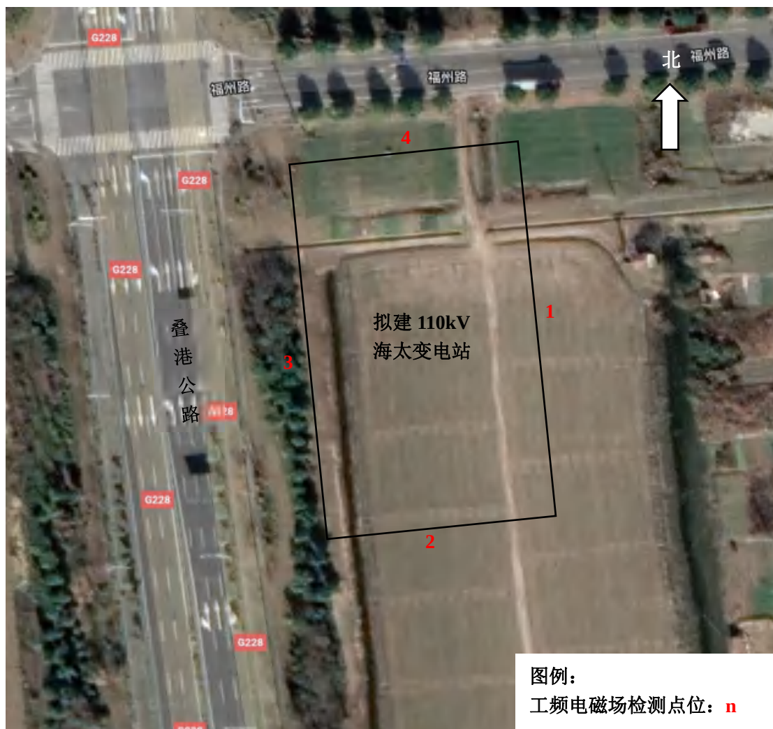
图 2-1 变电站工频电磁场环境检测点位示意图
