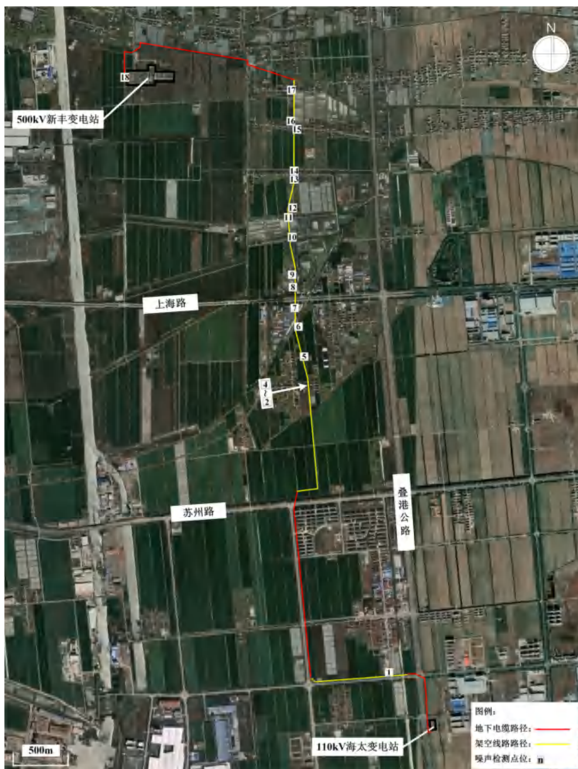
图3-3 新丰~海太线路路径沿线噪声检测点位布设示意图
