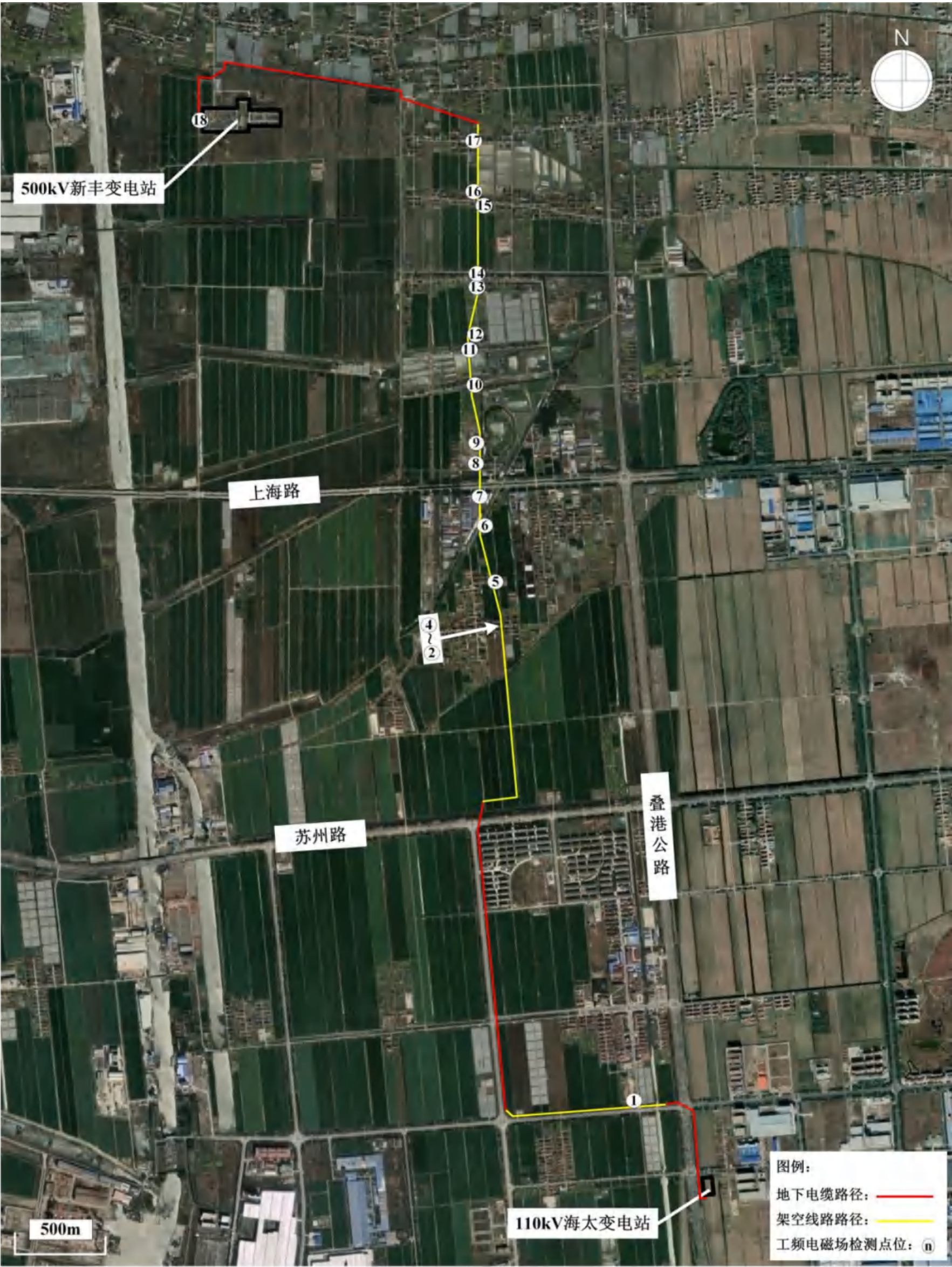
图 2-3 新丰~海太线路路径沿线工频电磁场检测点位布设示意图
